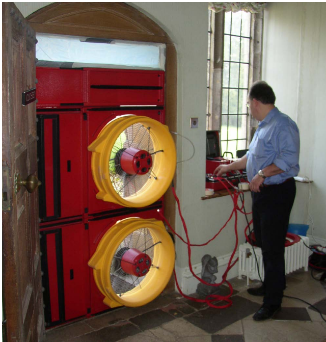
Ffigur 10: Defnyddir profion gwasgeddiad aer i ganfod beth yw aerglosrwydd yr adeilad a faint o aer sy'n gollwng trwy amlen yr adeilad (© Oxley Conservation).
