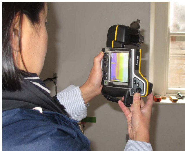
Ffigur 9: Pan gaiff ei ddefnyddio ar y cyd â phrawf gwasgeddiad aer, gall delweddu thermol ddangos yn glir ble mae'r aer yn gollwng trwy amlen yr adeilad.
