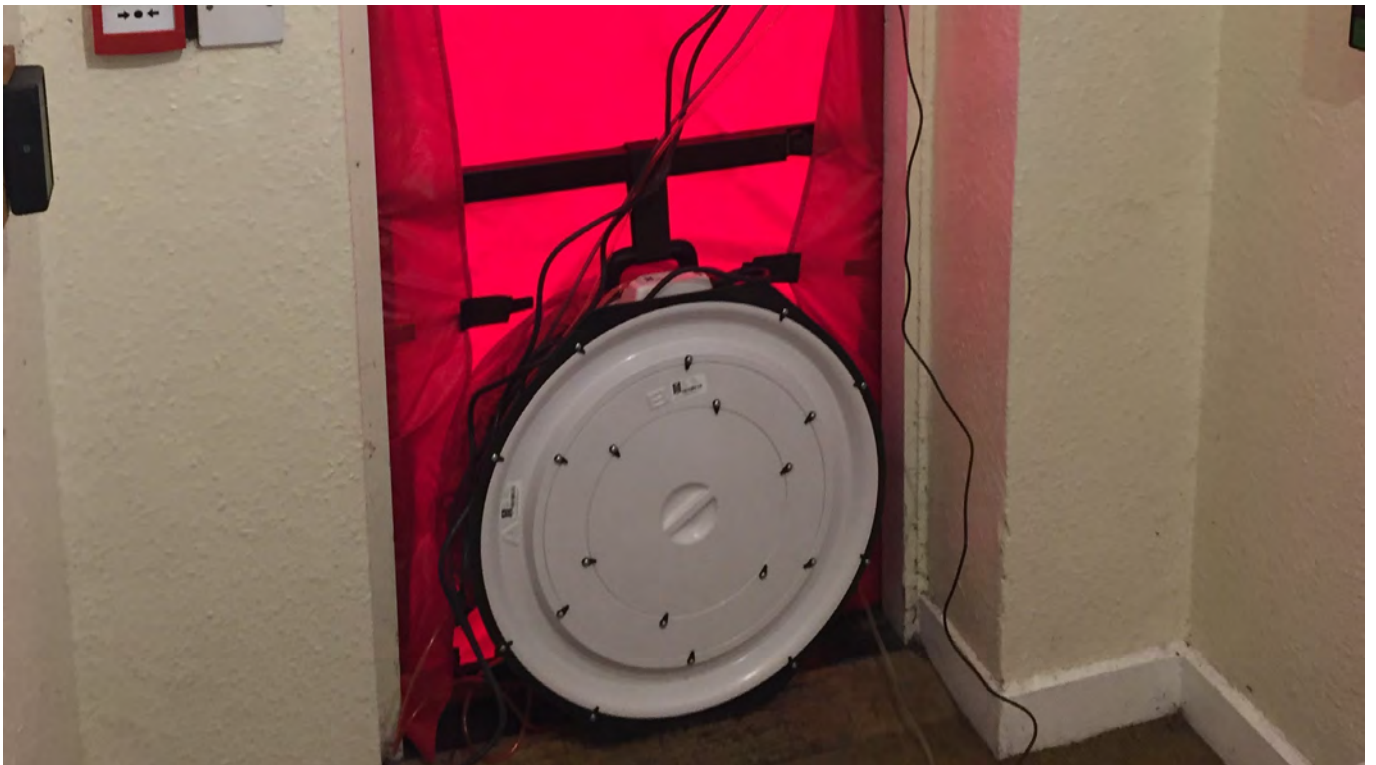
Chwith: Prawf gwasgeddiad gwyntyll neu'r 'blower door' method.
